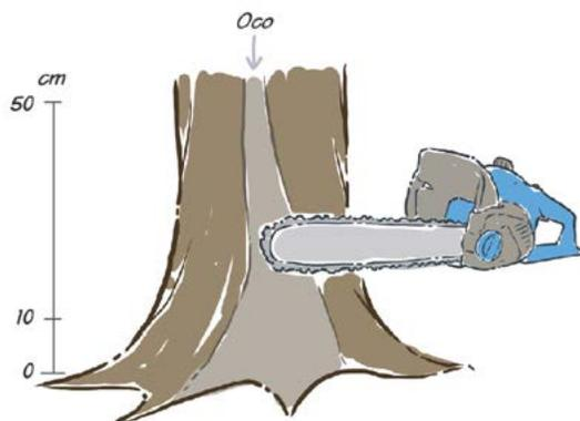
Figura 19 - Posição do corte para fazer o teste do oco, iniciando a entrada da motosserra com certa inclinação (20 graus), para evitar o rebote e diminuir esforço, terminar o teste com ela reta. Fonte: adaptado de IFT, 2011
