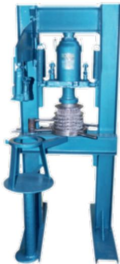
Prensa de óleo de funcionamento manual, desenvolvida pela Fundação Mussambê, a qual esmaga cerca de 200 kg de material por dia sem necessitar de uso de energia elétrica.
