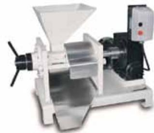
Prensa fabricada pela Ecirtec, dimensionada para o esmagamento de 40 kg de material/hora, acionada por motor elétrico.
