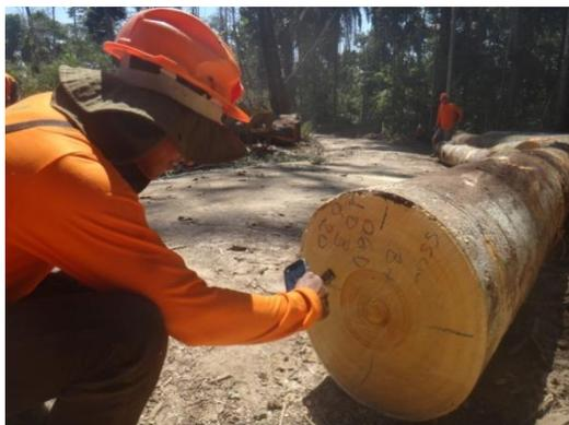
Figura 30. Marcação dos locais de medição das extremidades de toras durante o romaneio.
