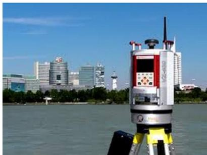
**Figura 23:** Sensor remoto terrestre a laser.
